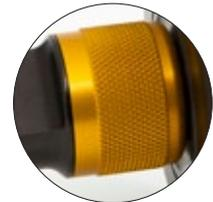
MULTIPLE CLICK SPHERICAL REBOUND ADJUSTER AT LOWER EYELET
